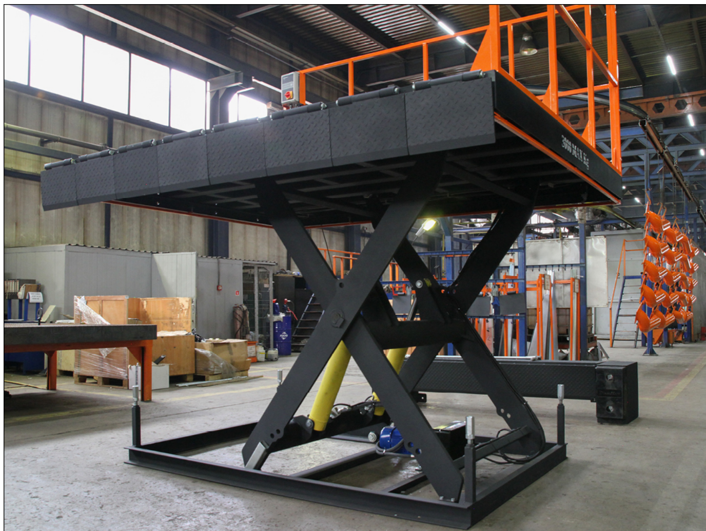
Подъемный стол с одной парой ножниц, выполненный с ограждением для безопасной работы оператора
